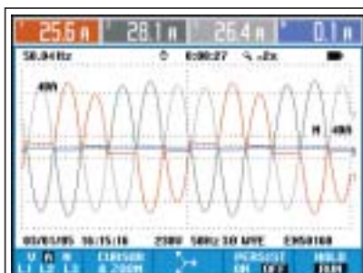
Abb. 4a - Signalformen vom Strom eines Sechsfach-Wechselrichters
