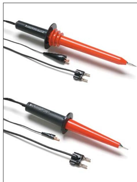
Bild 3: Hochspannungstastköpfe wie Fluke 80-K6 und 80K-40 erweitern die Spannungsmessbereiche bis 6 kV bzw. 40 kV.
