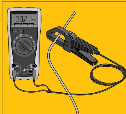
Stromzangen mit dem Transformator-Prinzip, wie z.B. Fluke 80i-400, messen Wechselstrom und wandeln den Messstrom in kleine Ströme am Ausgang. In diesem Fall 1 A in 1 mA.
