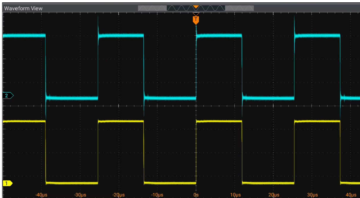
Abbildung 4: Vollständige Low-Side-Gate-Wellenform bei einer Busspannung von 20 V. Die Differenzsonde weist im Vergleich zur optisch isolierten Sonde ein erhöhtes Grundrauschen auf.
