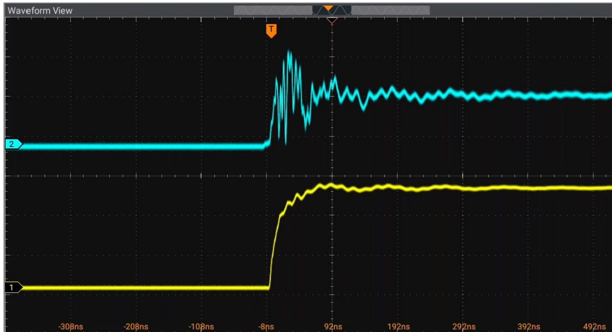
Abbildung 9: Vergrößerter Anstieg der High-Side-Gate-Übergangsflanke bei 20 V.
