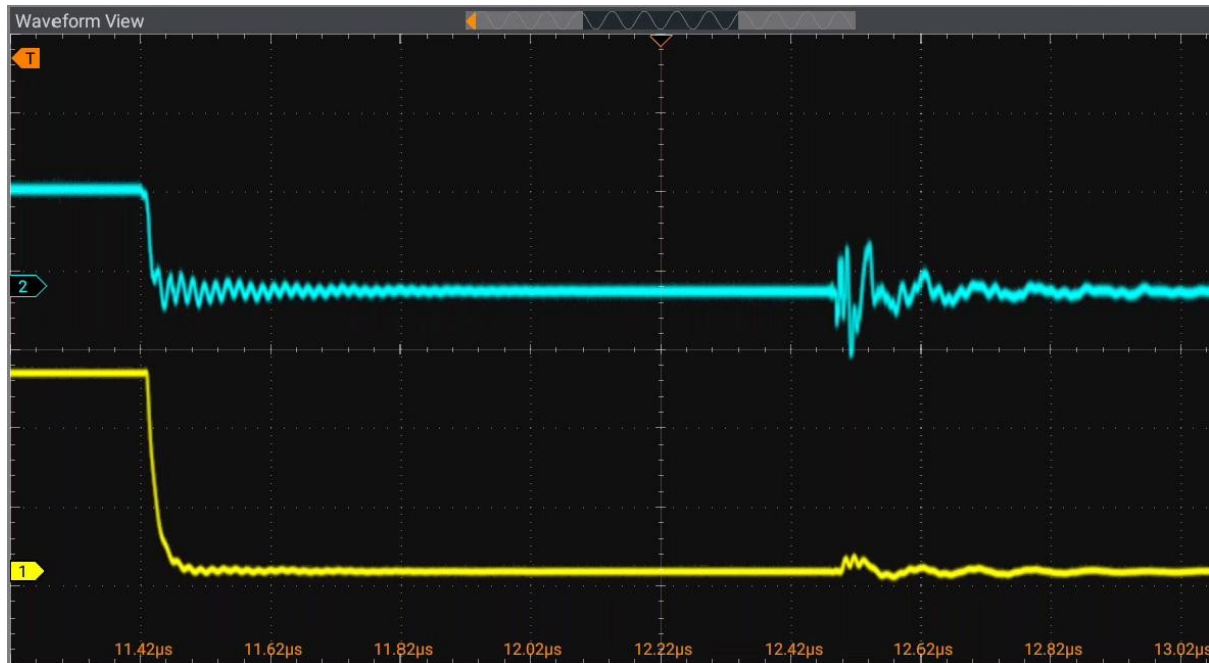
Abbildung 10: Fallender Übergang des High-Side-Gates bei 20 V.
