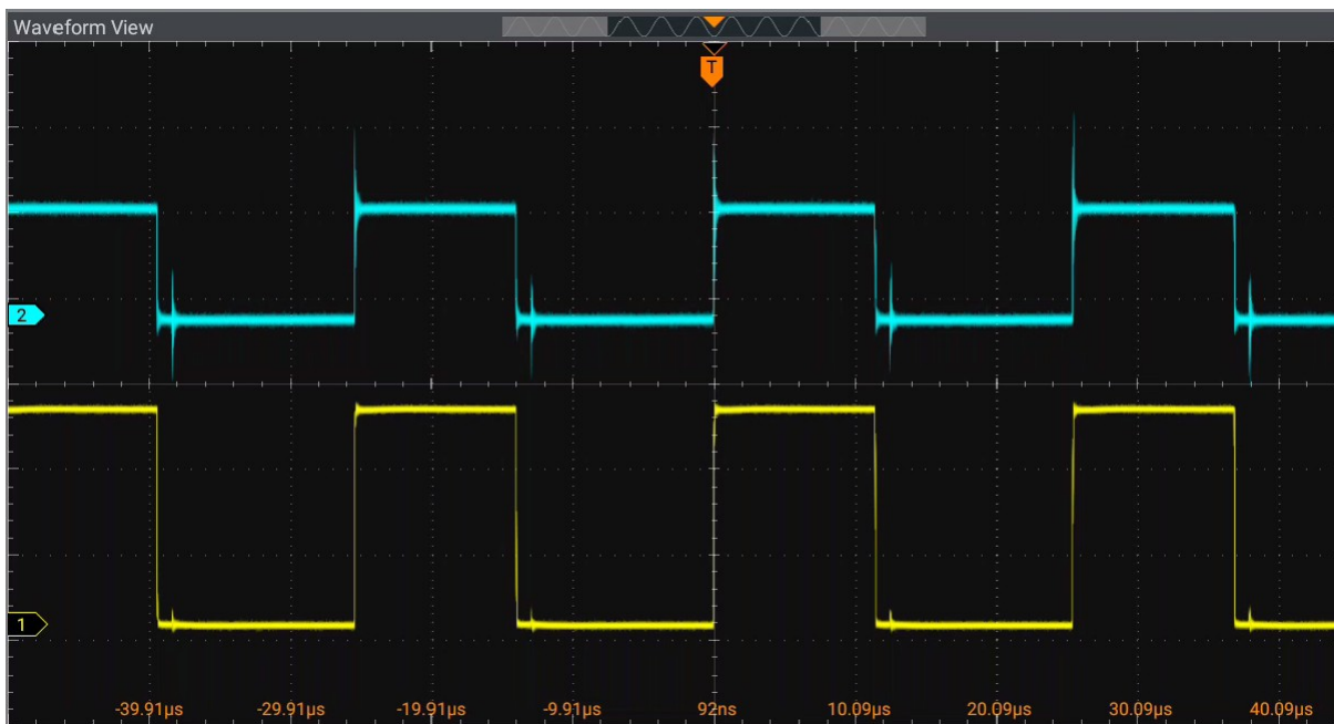
Abbildung 8: Vollständige High-Side-Gate-Wellenform bei 20 V Busspannung.
