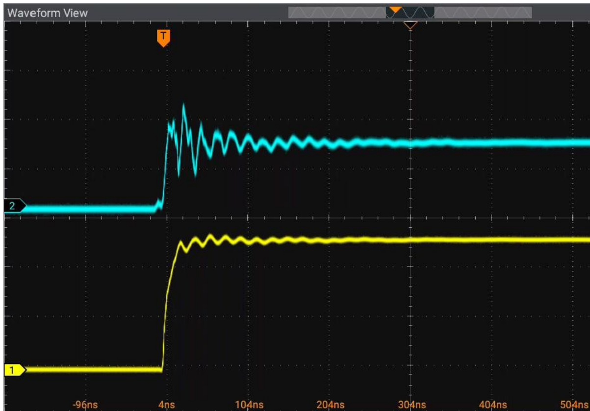
Abbildung 6: Vergrößerter L-GS-Übergang bei einer Busspannung von 80 V.
