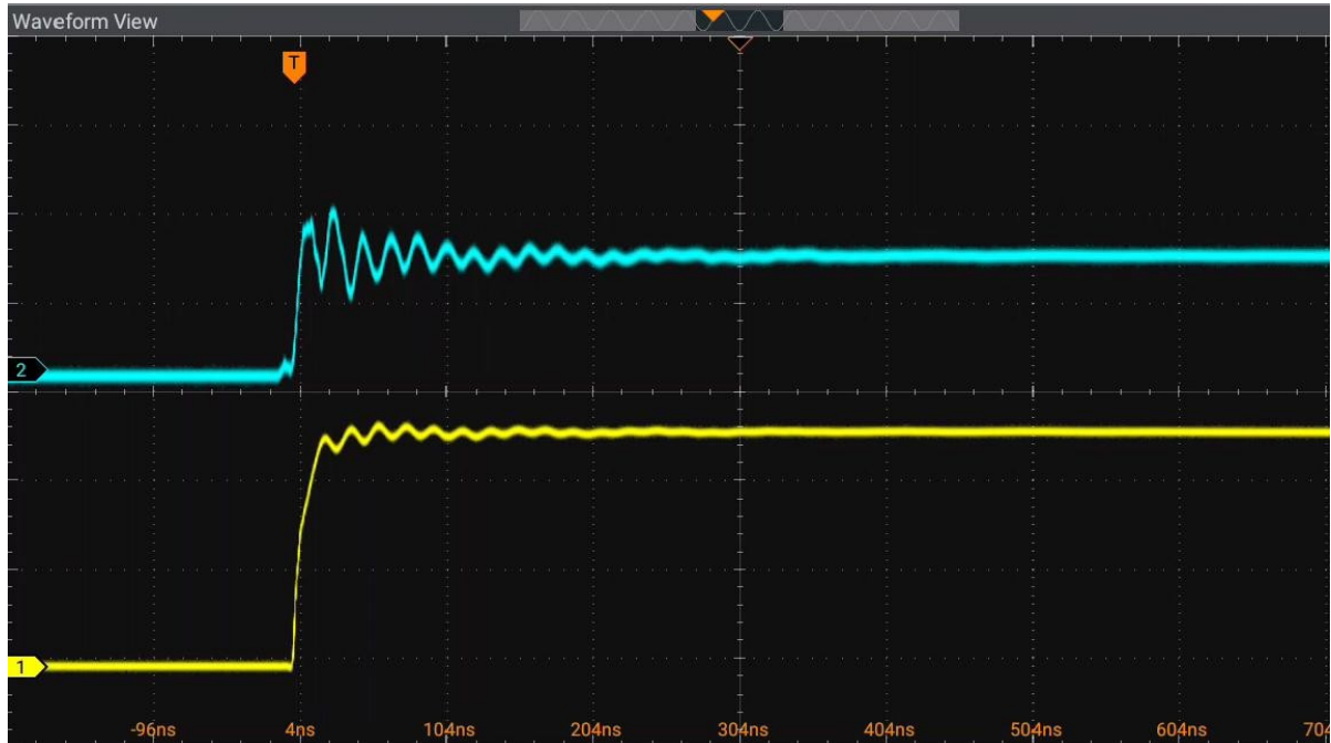
Abbildung 5: Vergrößerter L-GS-Übergang bei einer Busspannung von 20 V.
