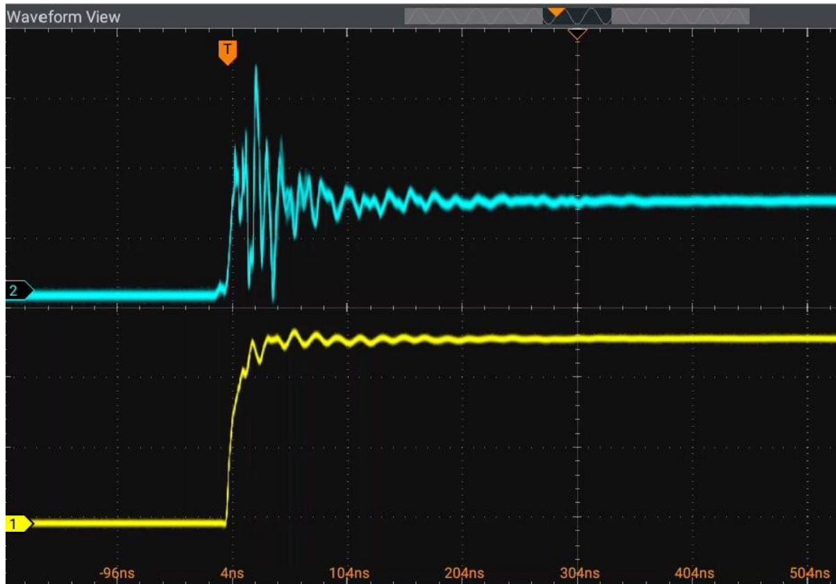
Abbildung 7. Vergrößerter L-GS-Übergang bei 300 V Busspannung unter hoher dv/dt -Belastung.
