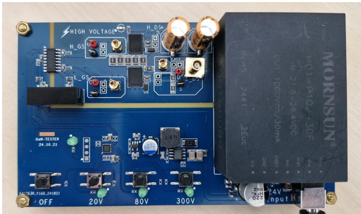
Abbildung 2. Hochspannungs-MOSFET-Schaltplatine mit wählbaren Busspannungspegeln.
