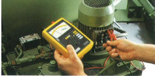
Isolationsprüfung an den Wicklungen eines Elektromotors.
