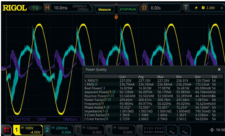
Bild 3. Messung der Qualität der Leistung am Netzteileneingang. (Bild: Rigol)
