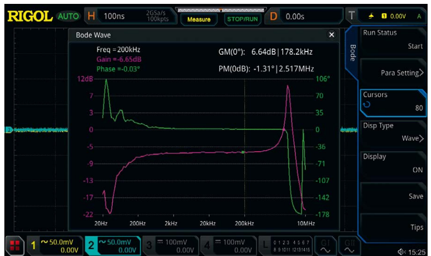
Bild 6. Messung der Verstärkung und Darstellung der Phase über den Frequenzbereich mit der Bodeplot-Funktion des MSO5000. (Bild: Rigol)
