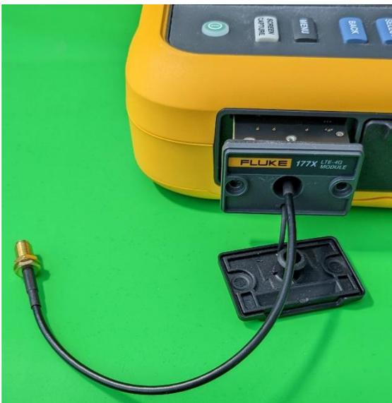
Gezeigt ist hier das Gerät mit dem LTE-Modul im vorgesehenen Steckplatz (das Modul ist mit zwei Kreuzschlitzschrauben gesichert).
