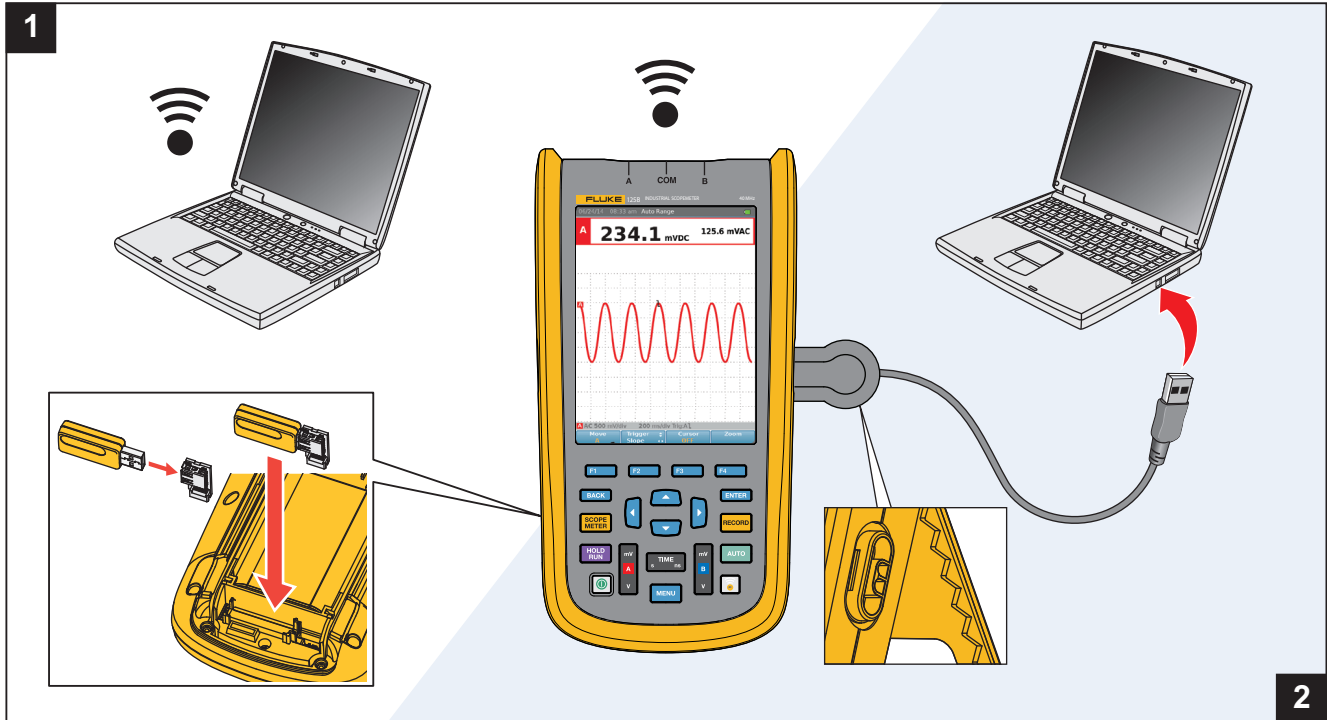
Abbildung 2. Kommunikation zwischen dem ScopeMeter Messgerät der Serie 120B und einem PC
