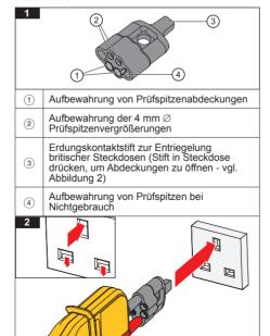
Abbildung 3 zeigt, wie die Prüfspitzen aus der Schutzkappe entnommen bzw. darin verstaut werden.
