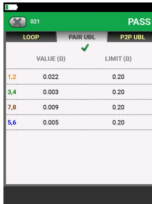
Alle 4 Paare haben nahezu den gleichen Widerstand.
