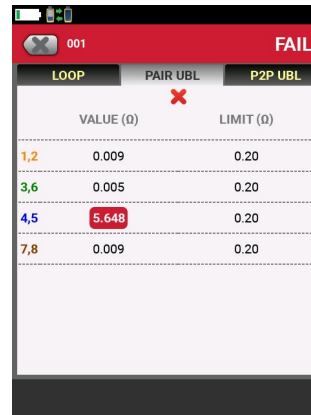
Übermäßiger Widerstand, der eine zeitweilige Verbindung verursachen könnte
