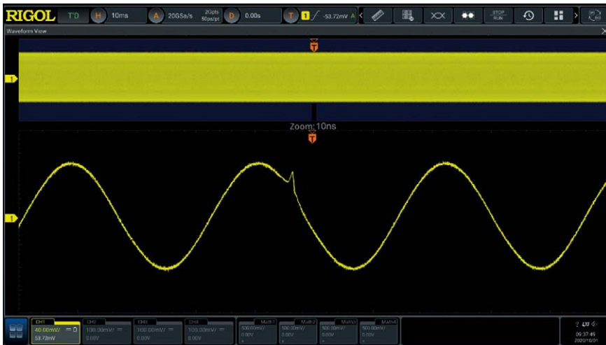
Bild 1. Der 2 Gpkt. tiefe Speicher erlaubt längere Messungen im Zeitbereich, die sich durch 20 GSa/s Abtastrate auch sehr fein auflösen lassen. Oben ist die gesamte Messreihe gezeigt, unten der vergrößerte Bereich, auf dem sich kleine Signaldetails noch erkennen lassen.
