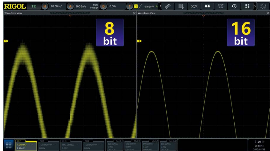
Bild 4. Vergleich von 8 bit vertikaler Auflösung und High-Resolution-Modus mit 16 bit vertikaler Auflösung.
