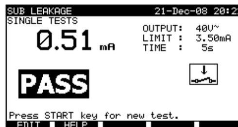
Beispiele von Ergebnissen der Messung des Ersatzableitstroms
