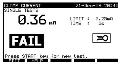
Beispiel eines Ergebnisses der Messung des Zangenstroms
