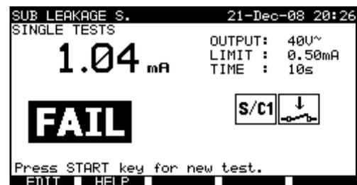
Beispiele von Ergebnissen der Messung des Ersatzableitstroms
