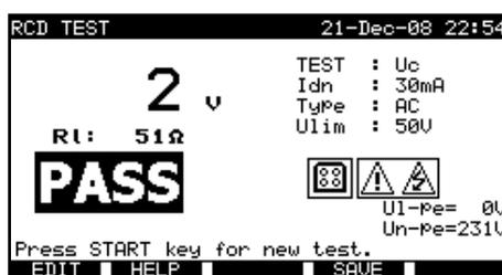
Beispiel für Ergebnisse einer Berührungsspannungsmessung
