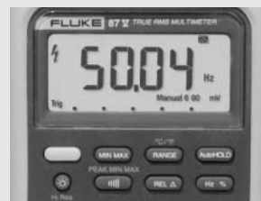
Abbildung 4. Ausgangsfrequenz (Motordrehzahl) mit Tiefpassfilter.
