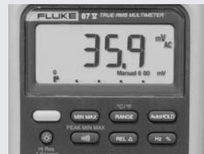
Abbildung 5. Ausgangsstromanzeige ohne Tiefpassfilter.
