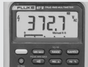
Abbildung 2. Ausgangsspannungsanzeige mit aktiviertem Tiefpassfilter.
