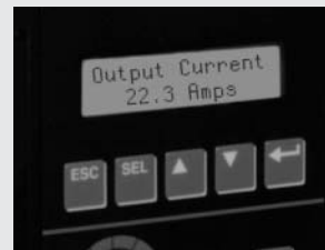
Abbildung 5. Ausgangsstromanzeige ohne Tiefpassfilter.
