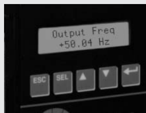
Abbildung 4. Ausgangsfrequenz (Motordrehzahl) mit Tiefpassfilter.
