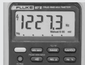
Abbildung 3. Ausgangsfrequenz (Motordrehzahl) ohne Tiefpassfilter.
