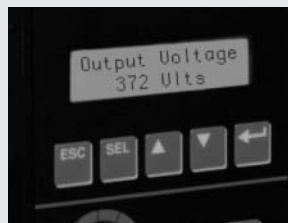
Abbildung 1. Ausgangsspannungsanzeige ohne Tiefpassfilter.
