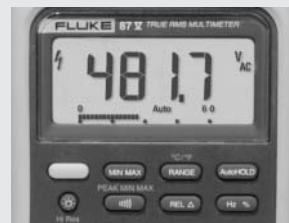
Abbildung 1. Ausgangsspannungsanzeige ohne Tiefpassfilter.
