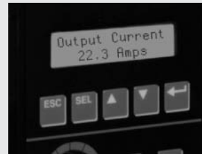
Abbildung 6. Ausgangsstromanzeige mit aktiviertem Tiefpassfilter.
