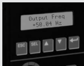
Abbildung 3. Ausgangsfrequenz (Motordrehzahl) ohne Tiefpassfilter.
