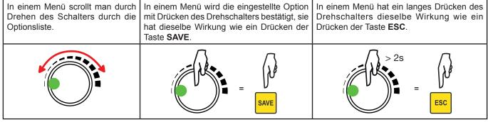
Beim manuellen Messen wird mit Hilfe des Drehschalters der Teststrom eingestellt.
