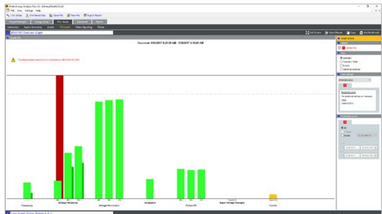
Fluke Energy Analyze Plus: Übersicht über den Zustand der Netzqualität
