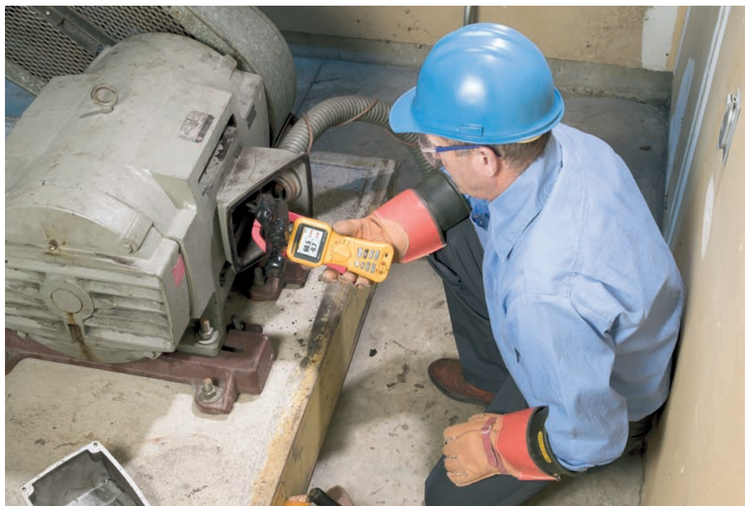
Abbildung 1. Auf der Doppel-Signalform-Anzeige des Fluke 345 werden sowohl Spannungs- als auch Stromsignalformen dargestellt.
