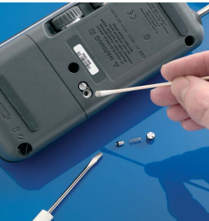
Die Reinigung der Flüssigkeitssammelöffnung des Druckkalibrators Fluke 718 erfolgt schnell, ist einfach und erfordert lediglich den Einsatz eines Schraubendrehers und eines Wattestäbchens.
